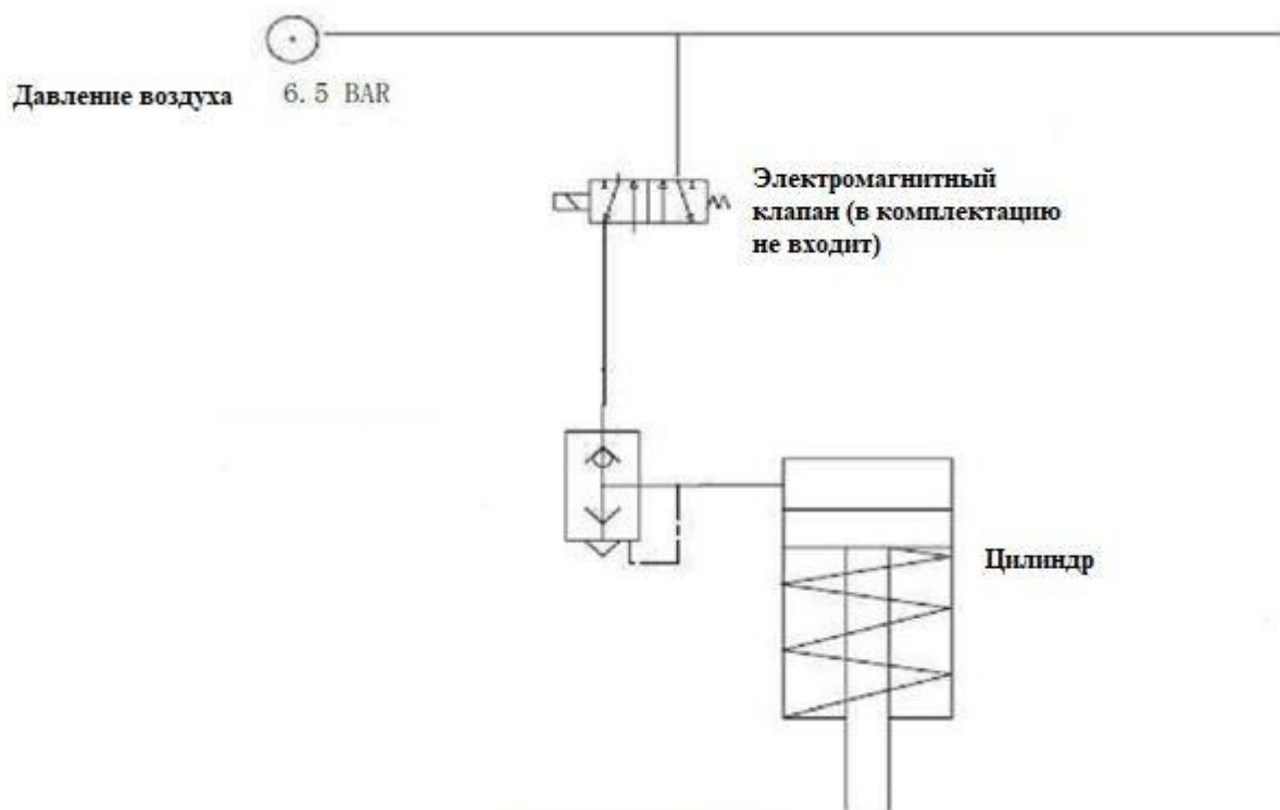
Рис. 5 Сверлильная голова. Подключение пневмоцилиндров
