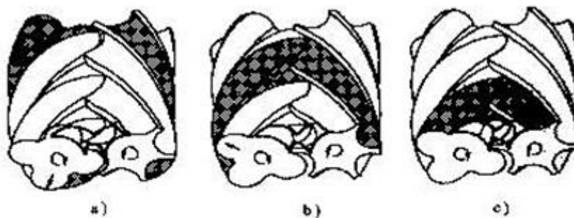
图 1-3 螺杆压缩机的压缩过程
