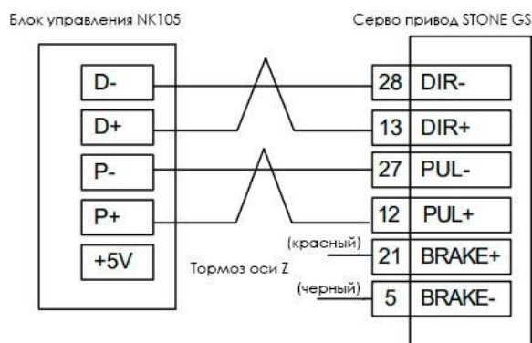
Рис. 72 Монтажная схема NK105 и серво привода STONE GS
