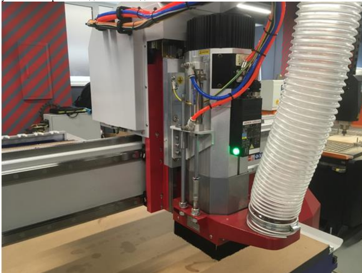
Рис. 75 Техническое обслуживание шпинделя
