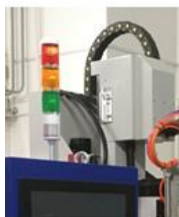
Рис. 6 Сигнальный фонарь. Индикация состояния станка.
