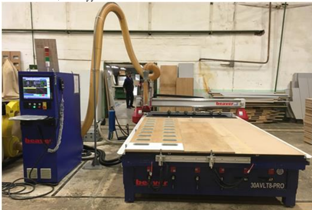
Рис. 77 Крепление заготовок с помощью вакуума
